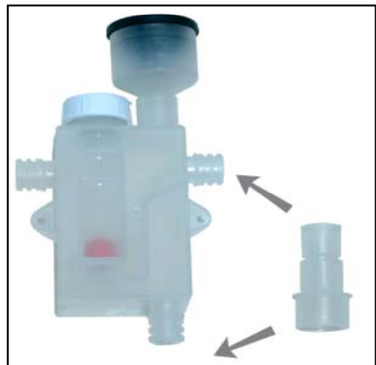
Sifón a seco con entradas y salidas horizontales y verticales completo de juntas toricas y conexión 20/26/32
