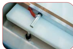
Barra de soldadura extraíble para facilitar limpieza.
