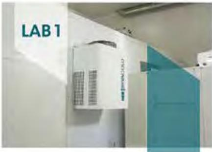
**LAB1** es una cámara climática de 300 metros cúbicos en cuyo interior se instalan tres celdas frigoríficas, que funcionan como calorímetros para probar el rendimiento de los monoblocos frigoríficos. Se pueden realizar mediciones de rendimiento, consumo de energía y eficiencia de acuerdo con prEN 17432, para sistemas de aire o agua. El LAB1 ha sido diseñado para probar el rendimiento de refrigeración con temperaturas ambiente de 0 ° C a +55°C y con temperaturas de cámara de hasta -40°C.
