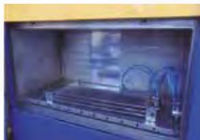
◀ Prueba de estanqueidad (con helio y/o nitrógeno a 30 bar)
