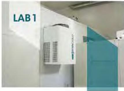
**LAB1** es una cámara climática de 300 metros cúbicos en cuyo interior se instalan tres celdas frigoríficas, que funcionan como calorímetros para probar el rendimiento de los monoblocs frigoríficos. Se pueden realizar mediciones de rendimiento, consumo de energía y eficiencia de acuerdo con prEN 17432, para sistemas de aire o agua. El LAB1 ha sido diseñado para probar el rendimiento de refrigeración con temperaturas ambiente de 0 ° C a +55°C y con temperaturas de cámara de hasta -40°C.
