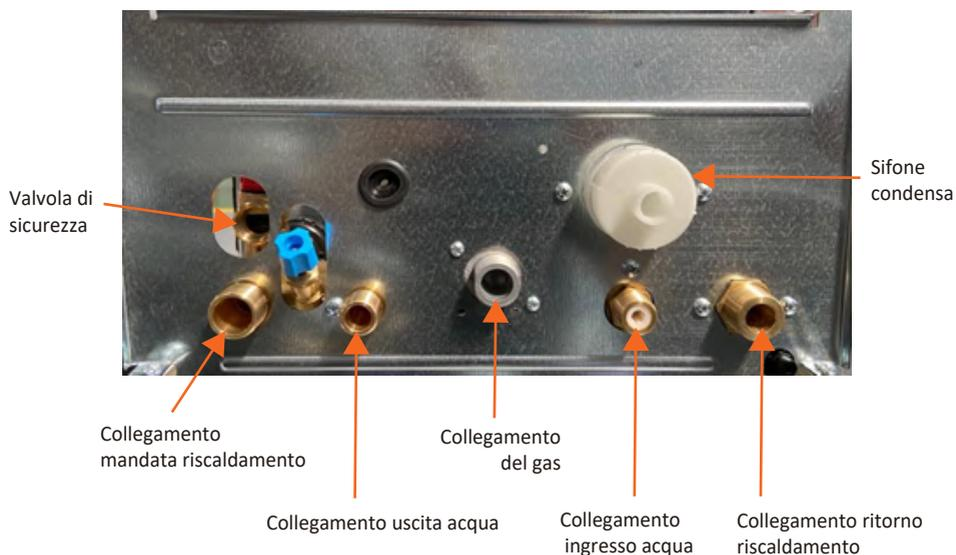
**ATTENZIONE:** Il collegamento del sifone e della valvola di sicurezza deve essere fornito alla linea di drenaggio dell'impianto.
