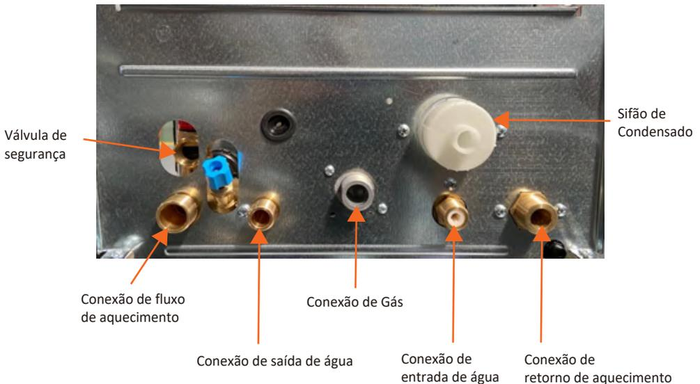
**AVISO:** A conexão do sifão e da válvula de segurança deve ser fornecida à linha de drenagem da instalação.
